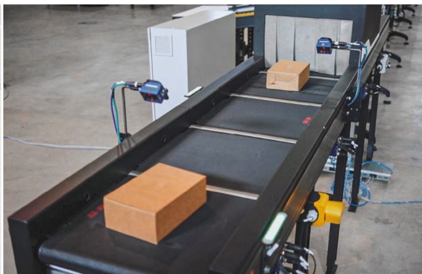
Förderband mit LED-Stripes und SKU-Barcode Scanner (vorne) sowie CLUSTAG RFID-Technologie
