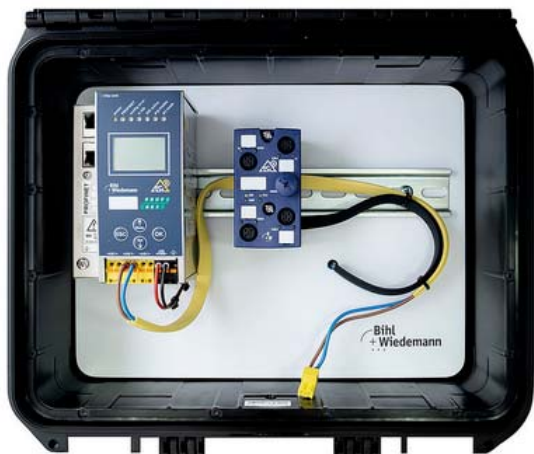
Abb. Das kleine Startset ASI-5/IO-Link beinhaltet u. a. ein ASI-5 PROFINET Gateway (BWU3847) oder ein ASI-5 EtherNet/IP-Gateway (BWU4229).
