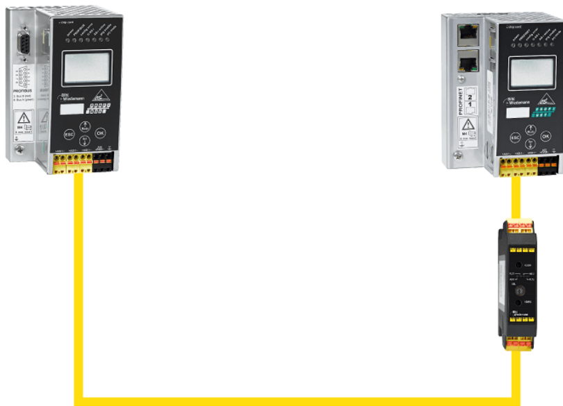
Fig. 3 : Échange de données simple indépendant des bus de terrain utilisés
