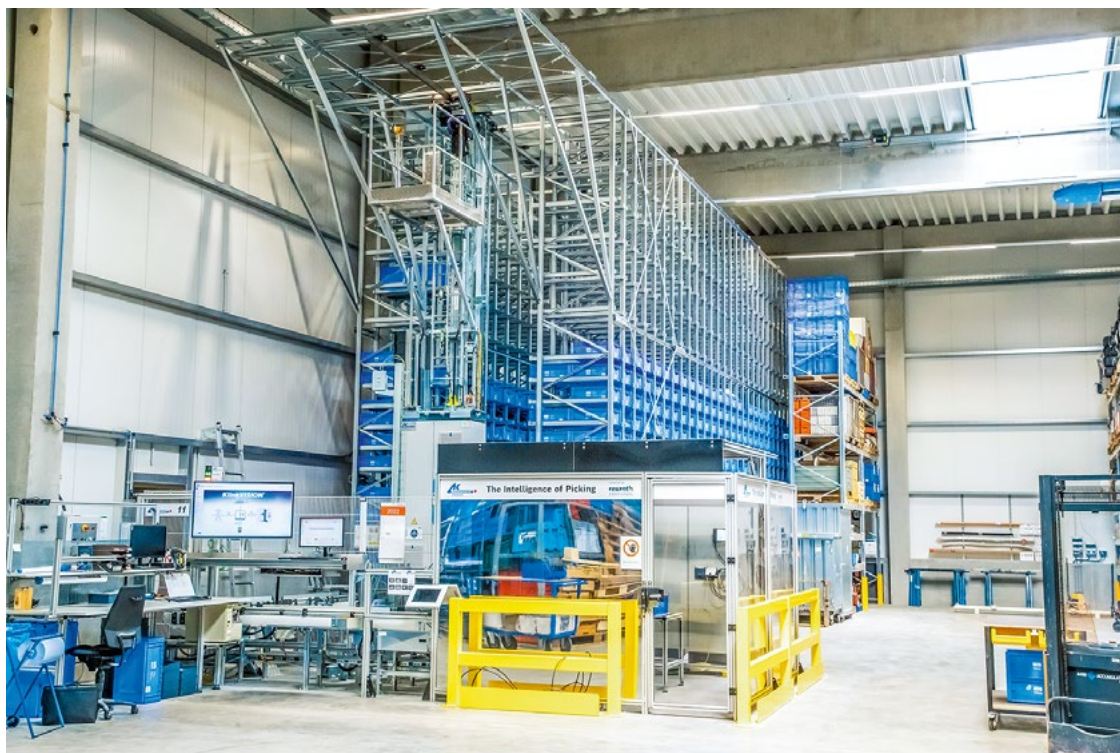
Aplicación Klinkhammer: dispositivo de mando para estanterías con almacén de estantes elevados
