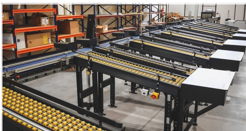
Mit dem RIELEC Fit Sorter Paketsortierer lassen sich bis zu 1800 Kartons in einer Stunde sortieren.
