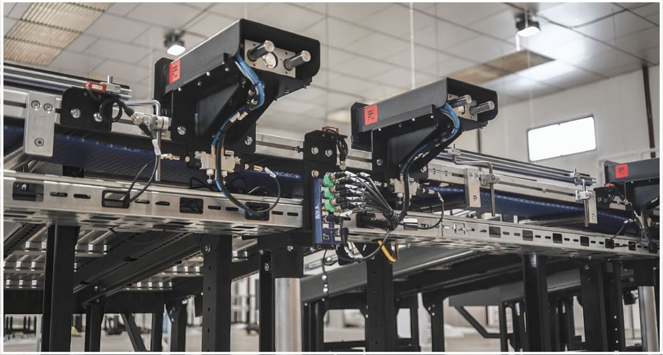
Los módulos de E/S autoconfigurables ASI-5 BWU4231 de Bihl+Wiedemann se utilizan para integrar sensores ópticos y actuadores neumáticos para expulsar paquetes.
