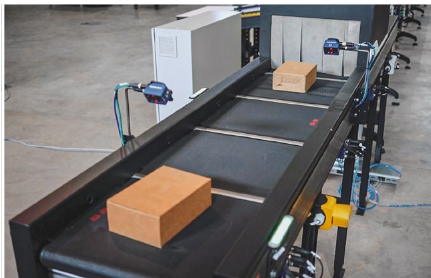
Cinta transportadora con tiras LED y escáner de código de barras SKU (delante) y tecnología RFID CLUSTAG.
