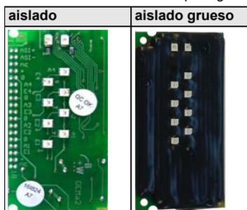
(4) **Indicadores LED de estado:** Los LEDs indican el estado de las entradas y salidas. Además, ambos LEDs ASi (PWR verde y FAULT rojo) indican también el estado de los esclavos ASi. Uaux se indica mediante un LED verde.
